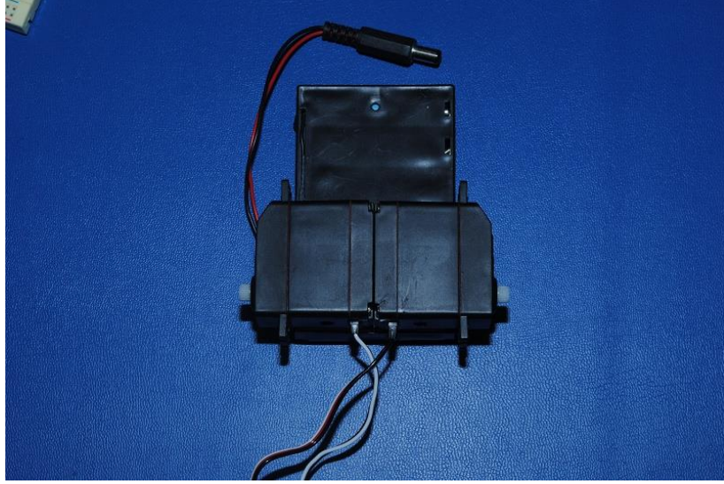
ŞEKİL.2.1.4. Pil yatağı ve servo motorlar
