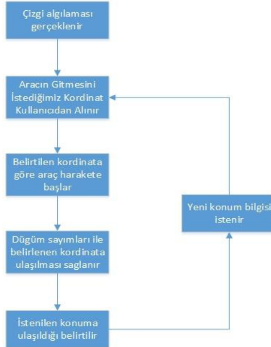
Şekil 5.3 Projenin Genel Yapısını Gösteren Akış diyagramı
