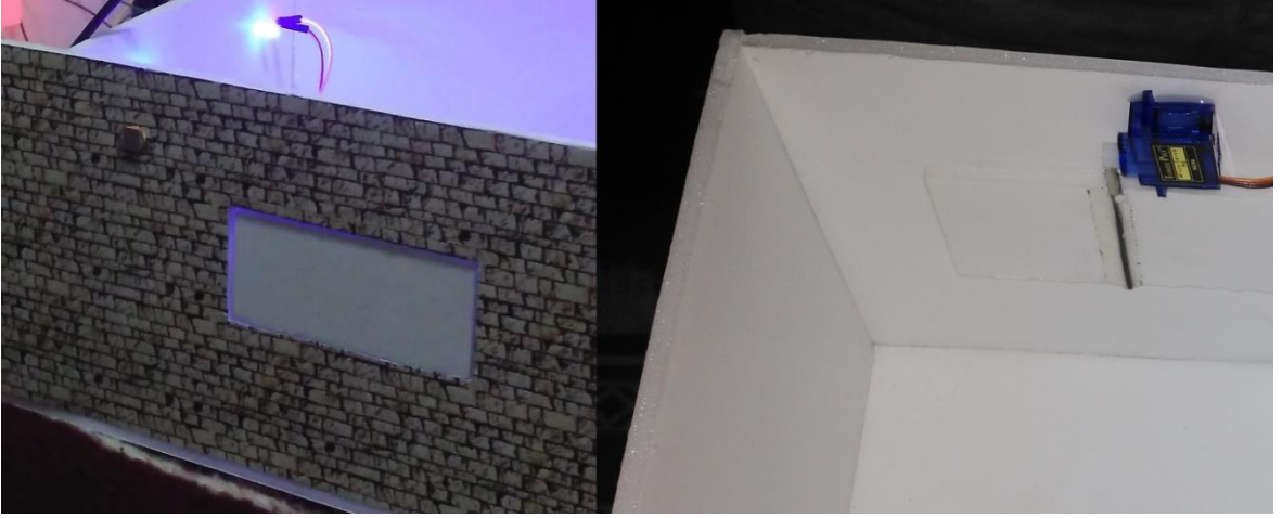
Şekil 26: Işık Sensörü Değerine Göre Pencere Kontrolü
