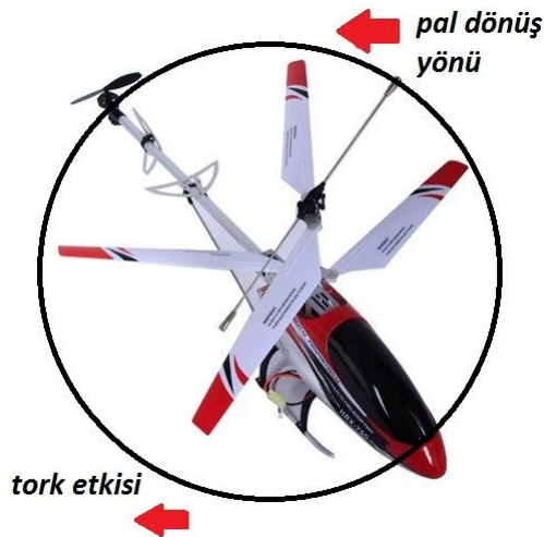
Şekil-5 Pal yönü ve tork etkisi
