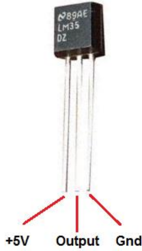
Şekil 2.1.3 LM35 Bacak bağlantıları
